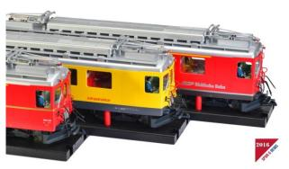
Nach Ablieferung von acht Allegra-Triebzügen stellte die Schweizerische Rhätische Bahn (RhB) sieben ihrer Triebwagen ABe 4/4 II ab. Die Triebwagen 48 und 49 wurden zu Diensttriebwagen mit Werkstatteinrichtung umgebaut, gelb lackiert und sind seither als Xe 4/4 232 01 und 272 01 im Einsatz. Die viermotorigen Triebwagen erreichen eine Höchstgeschwindigkeit von 65 km/h.
